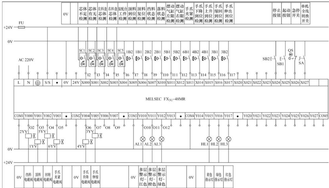
图 5-3 装配单元 I/O 接线图
