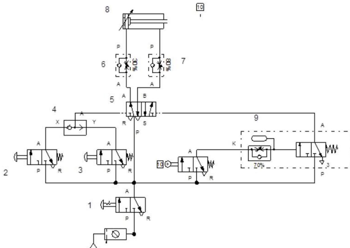
图 2-12 拉门自动延时关闭气压回路
