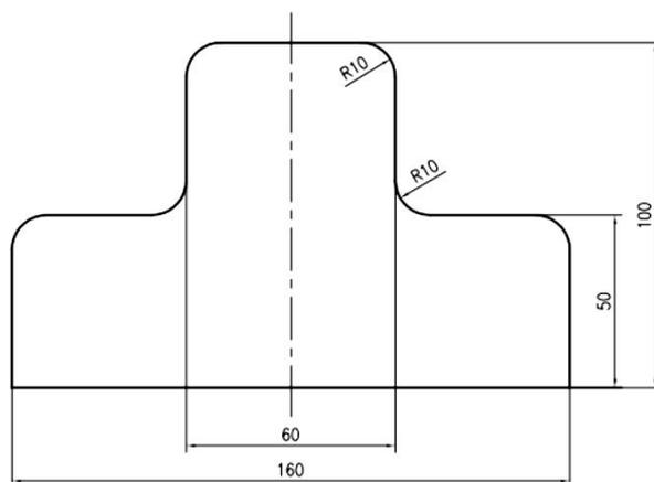
图 6-8 机器人运行轨迹平面尺寸图
