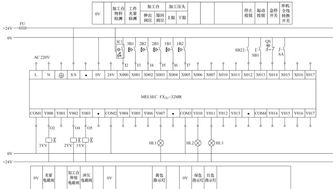
图 5-2 加工单元 I/O 接线图
