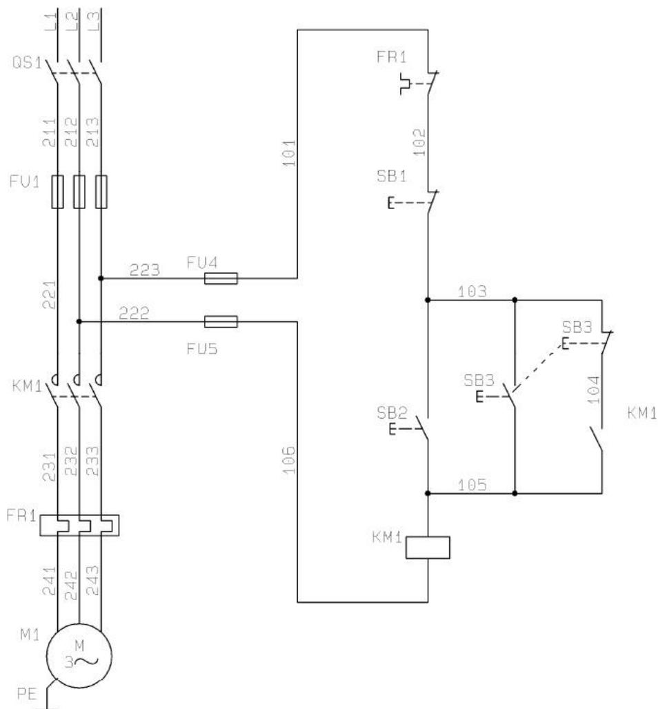
图 3-1 三相异步电动机点动和自锁控制线路
