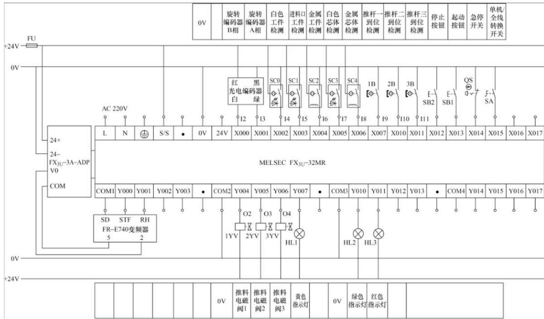
图 5-4 分拣单元 I/O 接线图
