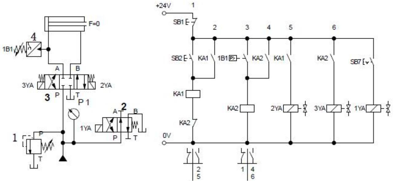
图 2-6 压力继电器控制液压缸动作及卸荷回路的液压回路和电气控制线路图
