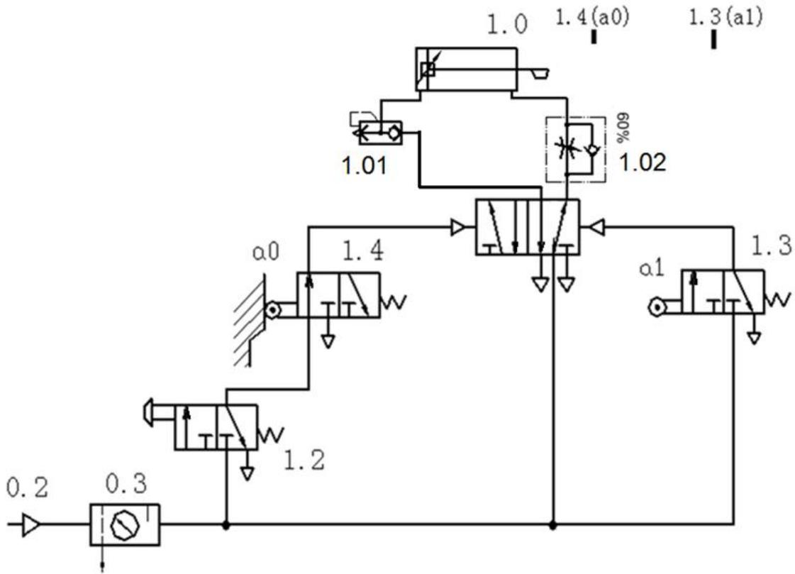
图 2-11 行程阀控制气缸连续往返气动回路
