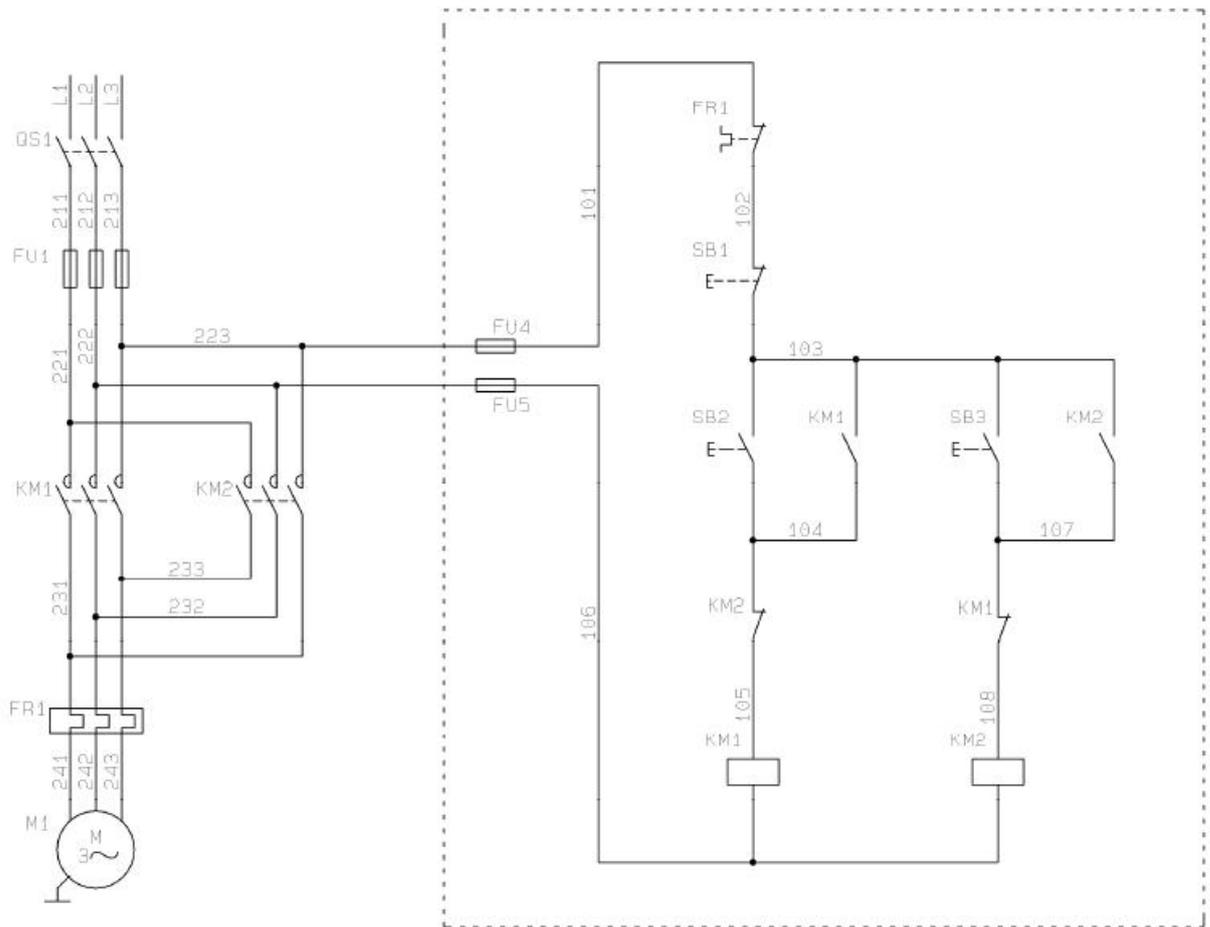
图 3-3 三相异步电动机的正反转控制线路
