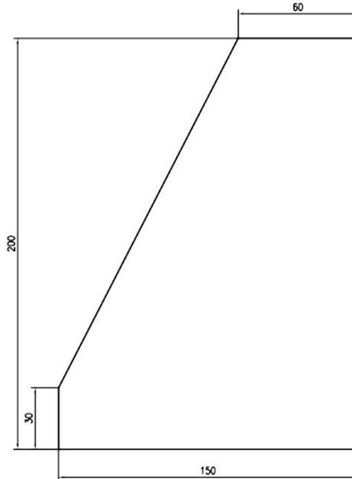
图 6-4 机器人运行轨迹平面尺寸图
