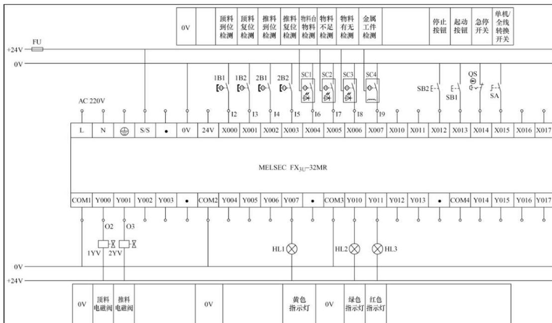
图 5-1 供料单元 I/O 接线图
