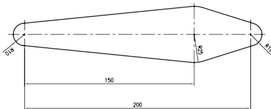
图 6-7 机器人运行轨迹平面尺寸图
