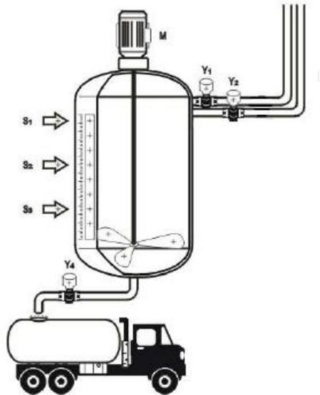
图 4-4 多种液体自动混合示意模拟图
