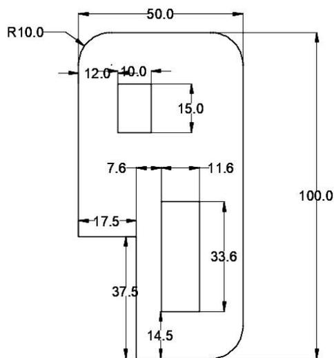
图 6-2 机器人运行轨迹平面尺寸图
