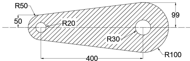
图 6-1 机器人运行轨迹平面尺寸图
