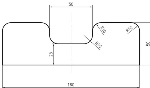
图 6-5 机器人运行轨迹平面尺寸图
