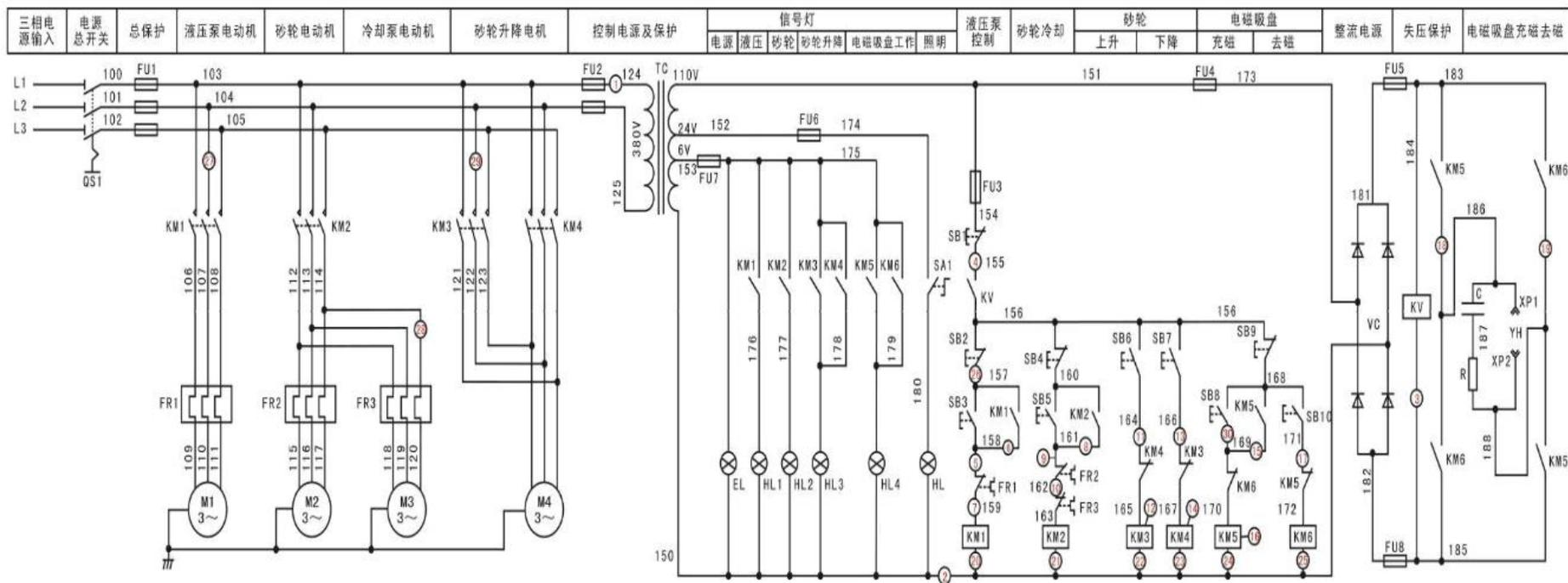
图 3-11 M7120 平面磨床电气控制线路故障图
