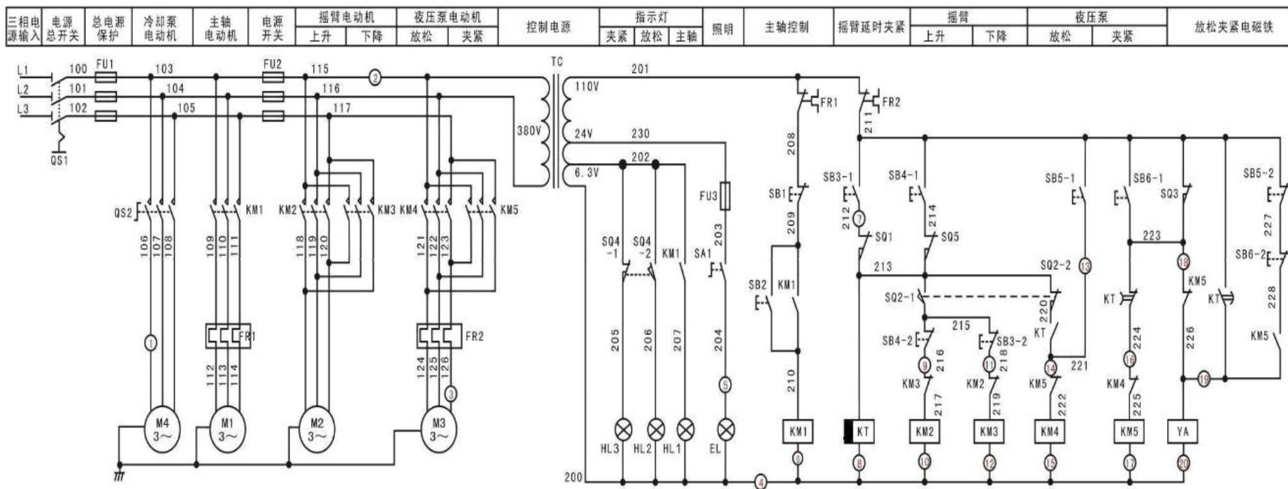
图 3-14 Z3050 摇臂钻床电气控制线路故障图
