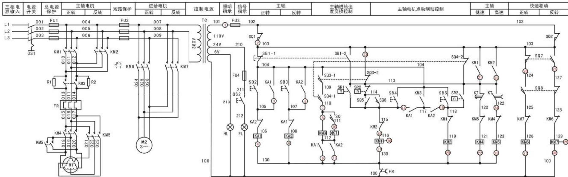
图 3-12 T68 卧式镗床电气控制线路故障图
