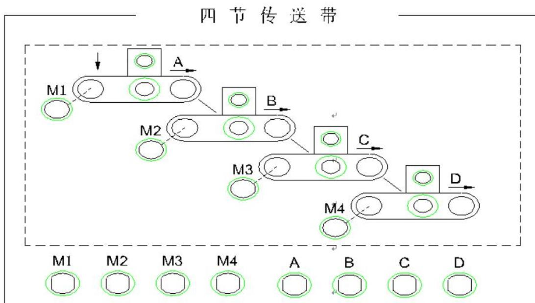
图 4-1 四节传送带装置模拟示意图
