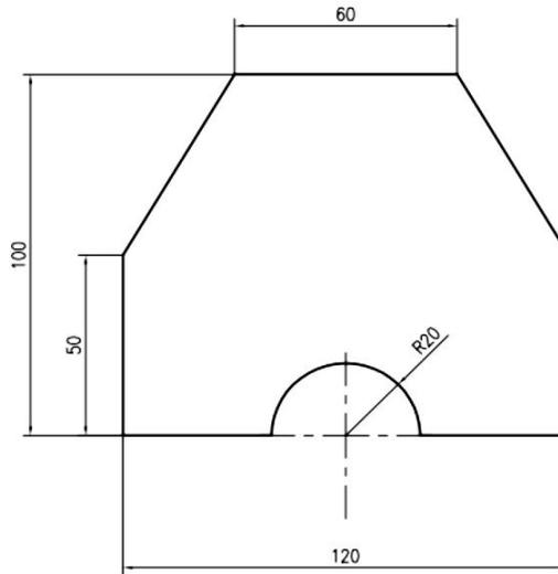
图 6-10 机器人运行轨迹平面尺寸图
