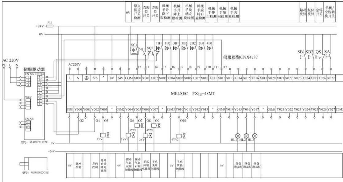
图 5-5 输送单元 I/O 接线图
