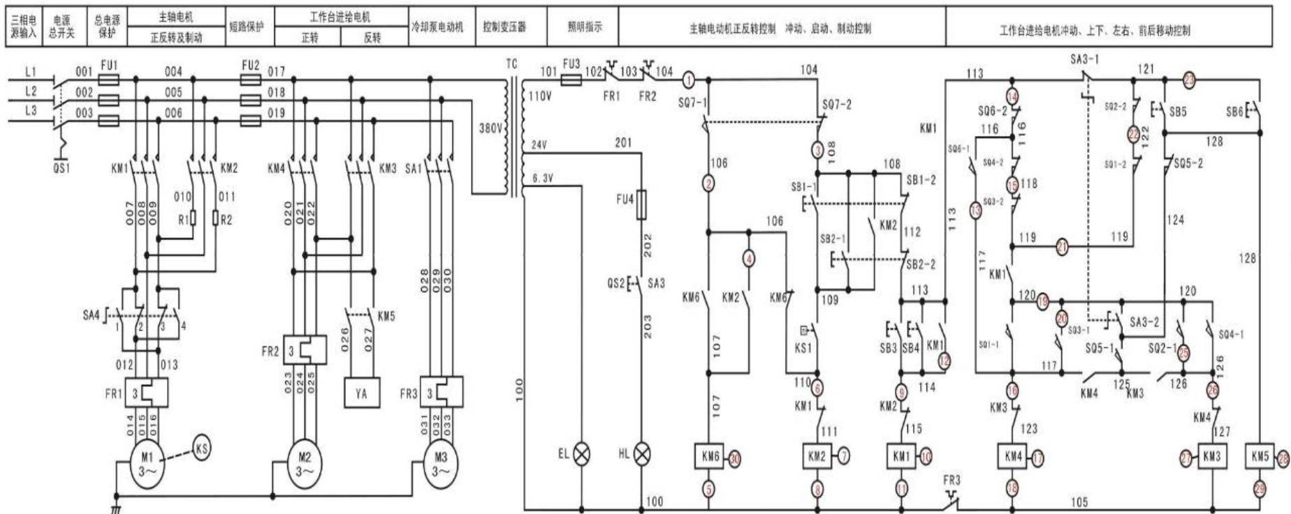
图 3-13 X62W 万能铣床电气控制线路故障
